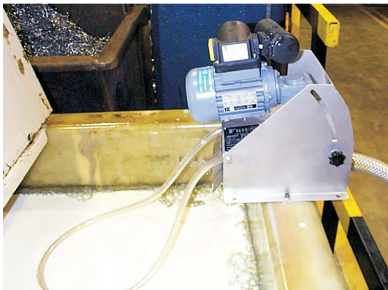
Déshuiler à tuyau modèle 1U à réservoir traitant de l'émulsion
